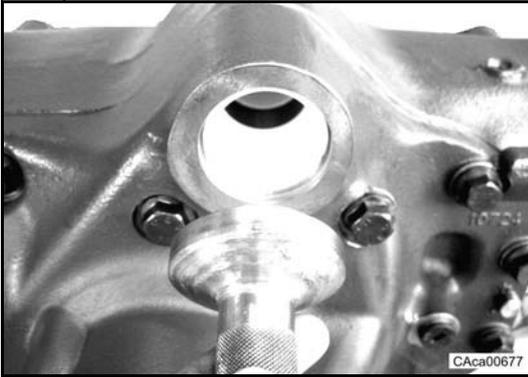
Poser dans la poutre d'essieu (1) la douille (14) à l'aide du chasoir CA715962 et d'un marteau.
