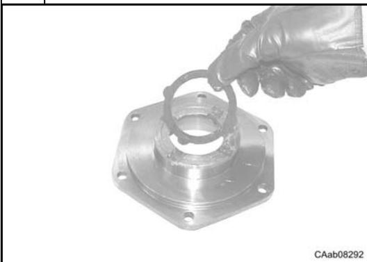
Reposer le plateau de pression du blocage du différentiel (19) avec le couvercle du boîtier (21) après avoir appliqué une fine couche de graisse.
