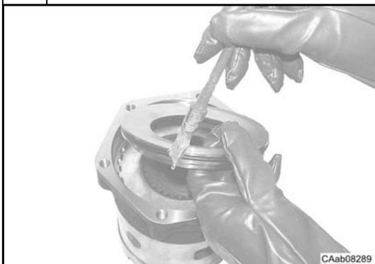
Lubrifier et poser des joints toriques neufs (16) et (17) sur le piston (18).
