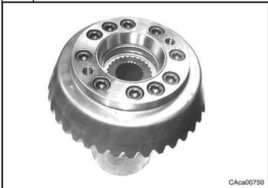
Appliquer de la pâte à joint du type spécifié sur le filetage des vis de fixation (1)
