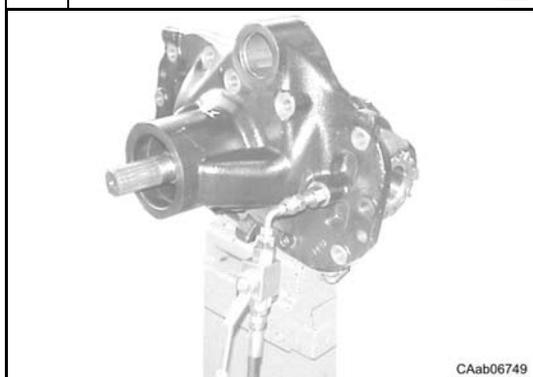
Envoyer de l'huile à la pression de **13÷15 bar** par l'orifice d'engagement du différentiel (voir C.5) pendant une durée de 3 minutes et vérifier l'absence de fuites d'huile.
