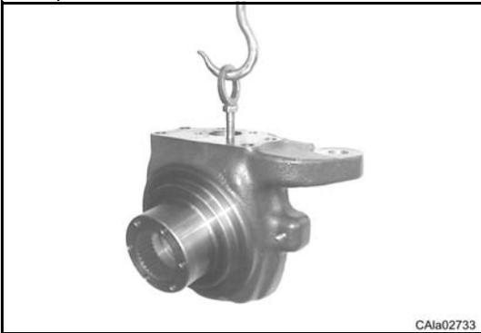
Extraire le porte-fusée (14) de la poutre d'essieu et du double joint de cardan.
