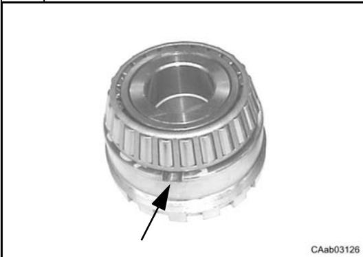
Déposer les cônes des roulements **(9)** et **(16)** en insérant un levier dans la fente indiquée.
