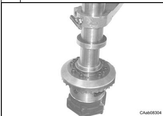
Poser la cuvette du roulement (1) à l'aide du chassoir CA715112.
