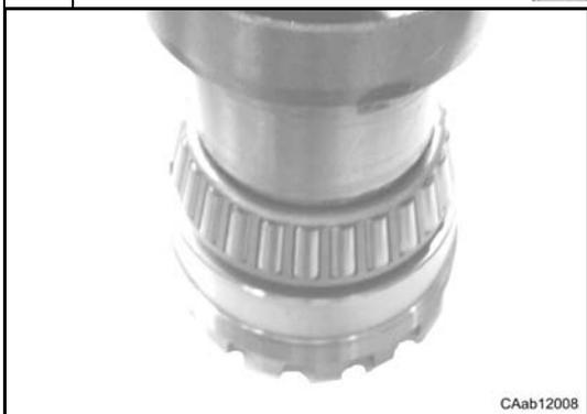
Poser le roulement (9) sur la bague de réglage (8) à l'aide du chasoir CA715046.
