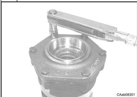
Dévisser toutes les vis de fixation (22) du couvercle (21) du boîtier de différentiel.
