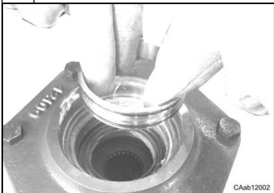
Déposer la bague d'étanchéité (27).
