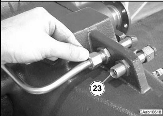
Déposer les conduites (24) et les raccords correspondants (23) du groupe poutre d'essieu.
