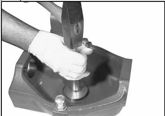
Chasser le roulement (13) dans le porte-fusée (14) à l'aide du chasoir CA715646 et d'un marteau ou d'une presse.
