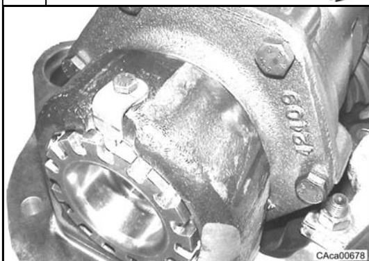
Avant de déposer les bagues (8) et (17), faire des marques indélébiles sur les bagues et le support du différentiel (10) pour ne pas risquer de les intervertir lors du montage.
