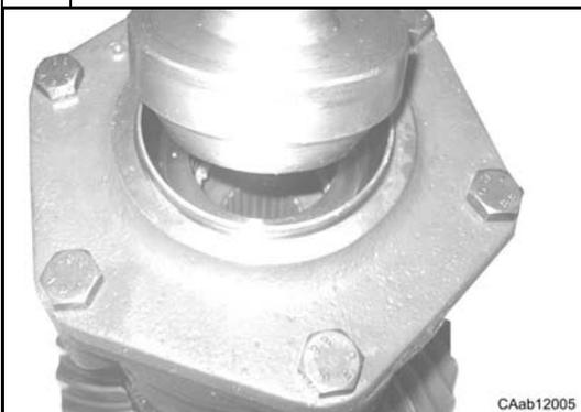
Reposer la cuvette du roulement (29) à l'aide du chasoir CA715583.
