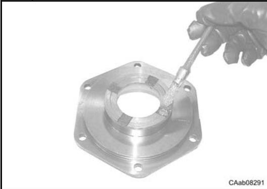
Graisser légèrement le logement du plateau de pression du blocage du différentiel (19).
