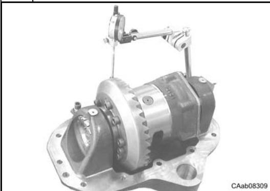
Placer un comparateur à base magnétique sur le support du différentiel en mettant sa pointe en contact avec la surface d'une dent de la couronne conique et perpendiculaire à celle-ci.
