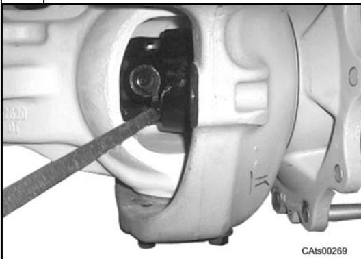
Introduire un levier entre le porte-fusée (14) et la poutre d'essieu et l'encastrer dans le double joint de cardan.
