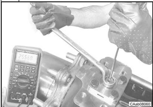
Régler la position du capteur à l'aide d'un tournevis comme le montre la figure.
